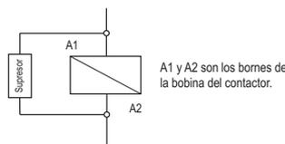
Esquema de conexión de supresores en cargas accionamiento directo
